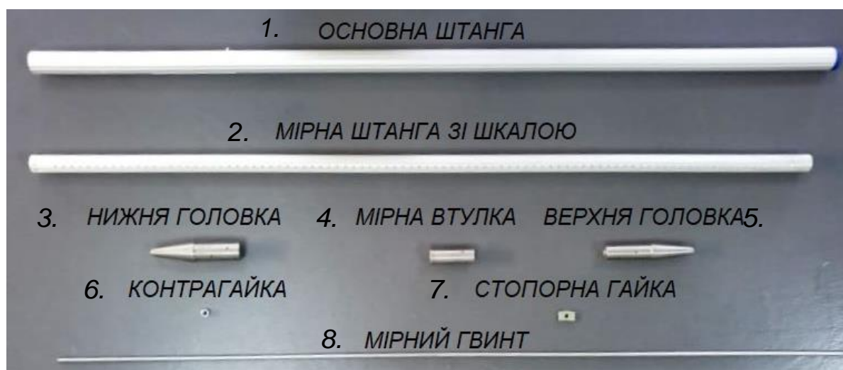
Рис. 2. Деталі інструменту «Довгомір»
