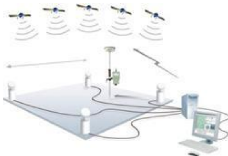
Рис. 2. Принципи роботи мережі базової станції RTK
