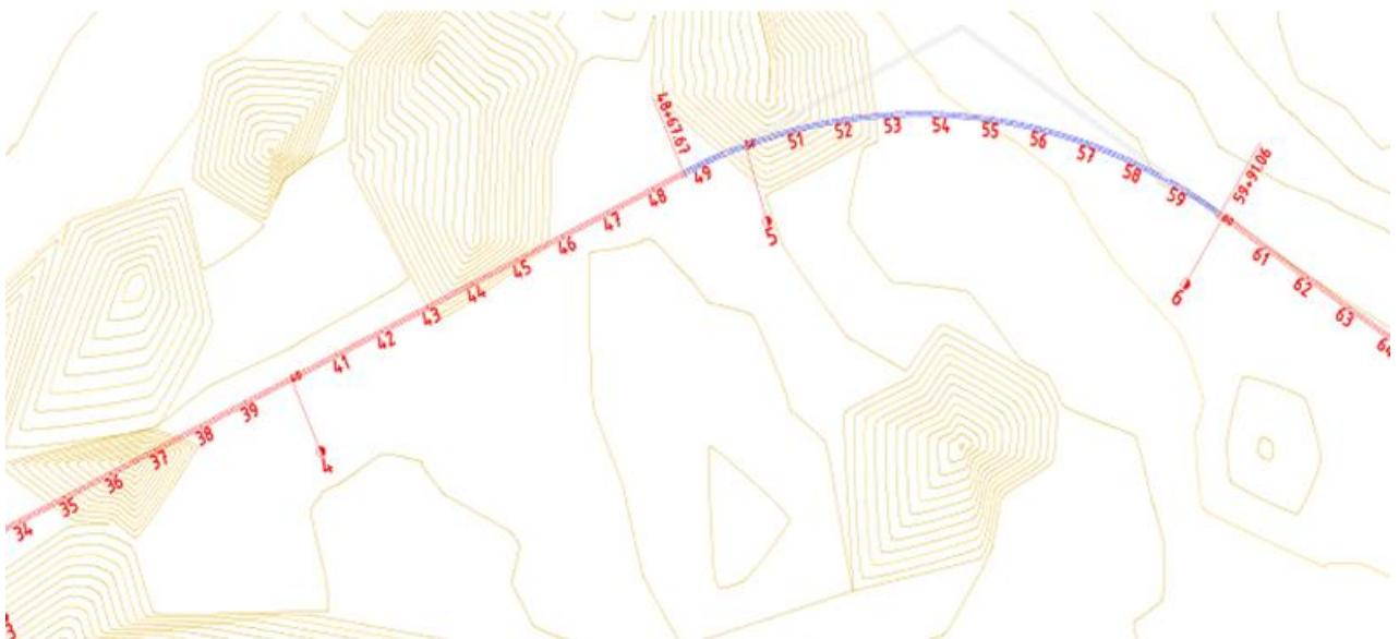
План траси автомобільної дороги побудований в програмного комплексі AutoCAD Civil 3D
